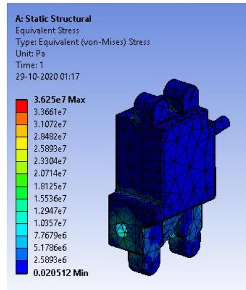
Fig. -4 : Stress Distribution Using Finite Element Analysis (FEA)
